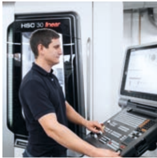
HSC 30 linear – 40.000 omw./min. en lineaire aandrijving zorgen voor μ-nauwkeurige productieresultaten ook in zwaar te verspanen grondstoffen, bijv. wolfram en koper.
