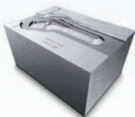
Smeedmatrijs voor heupnagel Machine: DMC 650 V Materiaal: 1.2343 Maat: 250 × 200 × 100 mm
