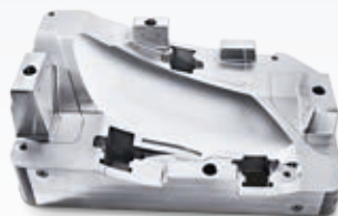
Spuitgietmatrijs voor koplampen Machine: HSC 70 linear Materiaal: 1.2312 Maat: 680 × 400 × 350 mm, Ra < 0,15 μm
