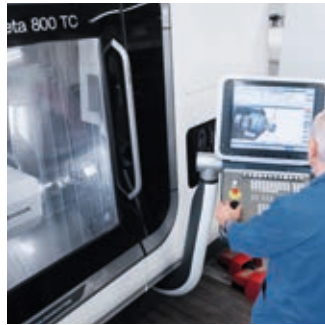
Dankzij de CTX beta 800 TC worden zeer nauwkeurige en complexe delen op slechts één machine compleet gedraaid en gefreesd.
