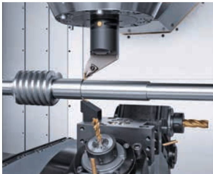
4-assen-bewerking met B-as en onderste revolver.
