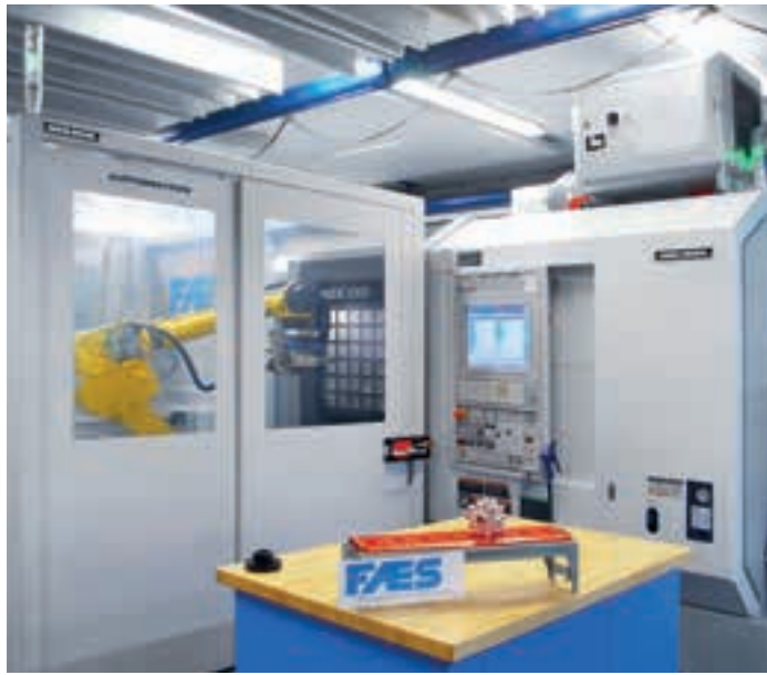
De ruwe- en einddeel-grijper van de handlingrobot WH25 zijn geconfigureerd voor delen met een gewicht van tot 25 kg.
