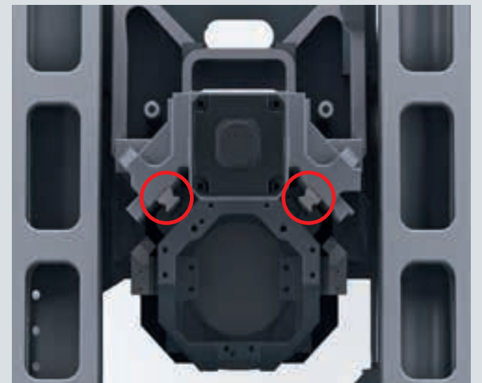
Hoogste stabiliteit door twee in een hoek gebogen geleidingen. Geleidingsbanen liggen buiten de spanenval.
