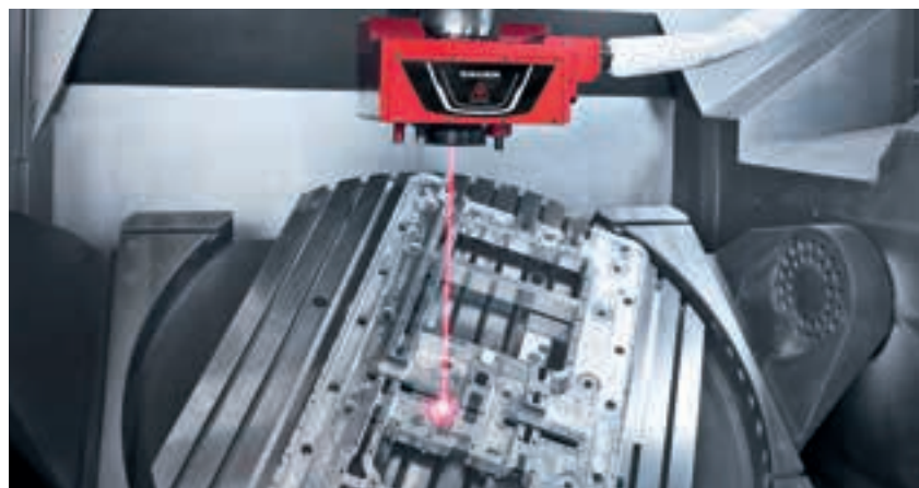
De mogelijkheid van het directe 5-assen-lasertextureren van vormgereedschappen op de LASERTEC 125 Shape vervangt het zeer dure en niet milieuvriendelijke etsen.
