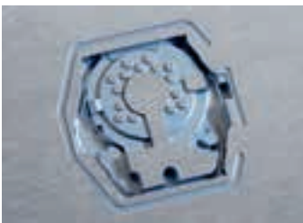
Laserafdragen: filigrane caviteiten in miniatuurvormen
