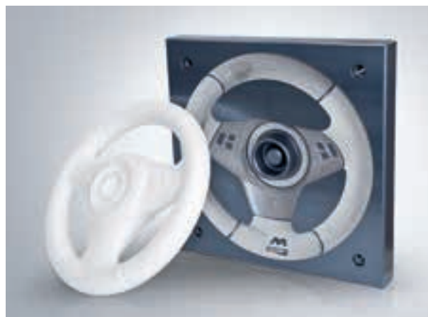
Stuur-schuimgereedschap uit aluminium en geschuimd monster met verschillende oppervlaktestructuren (o.a. wafel-, rooster-, ruitmonster-textuur).
