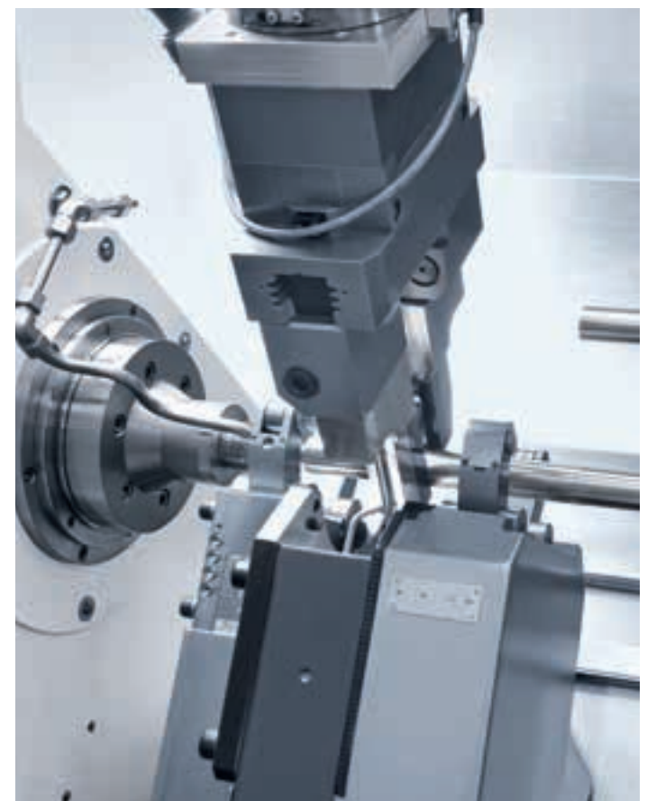
De bril in de CTX beta 800 linear dient ter stabilisering van het werkstuk, wanneer het afsluitende groef- en gat-frezen gebeurt.
