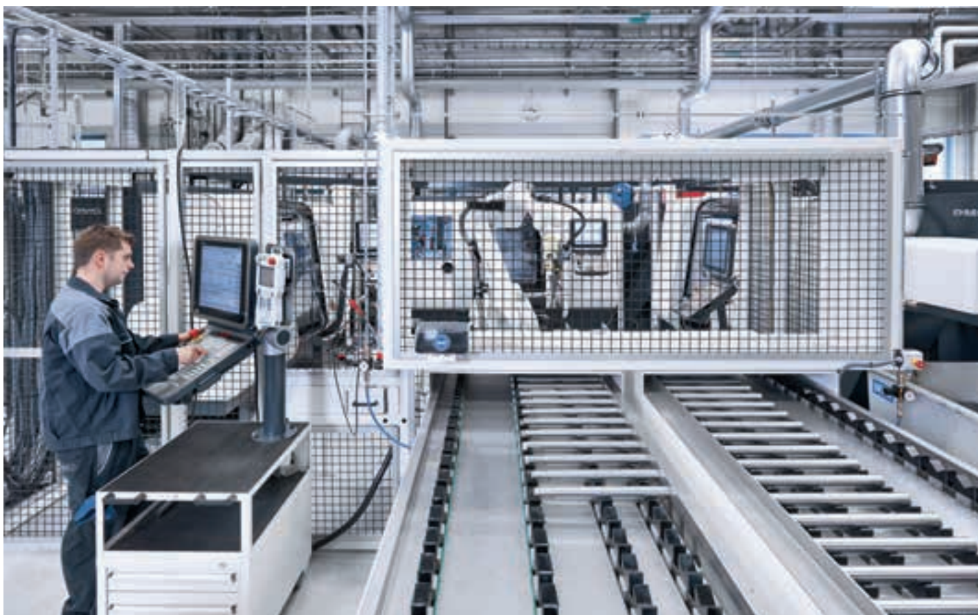
Twee transportbanden nemen de uitrusting en ontlading van de productiecel over. Het overige proces loopt volkomen automatisch.
