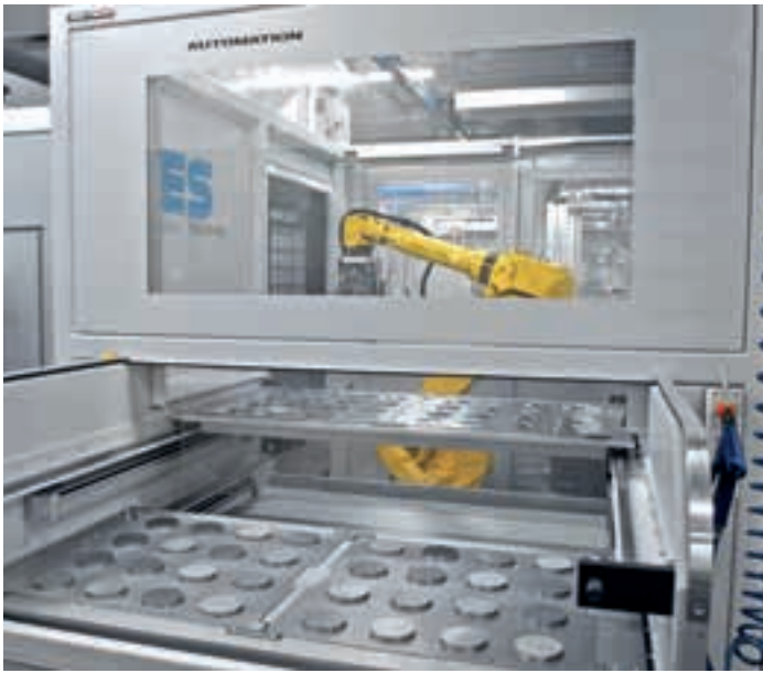
Het geïntegreerde werkstukmagazijn voor delen tot 300 kg per lade garandeert een zekere en efficiënte gereedzetting van de ruwe delen.
