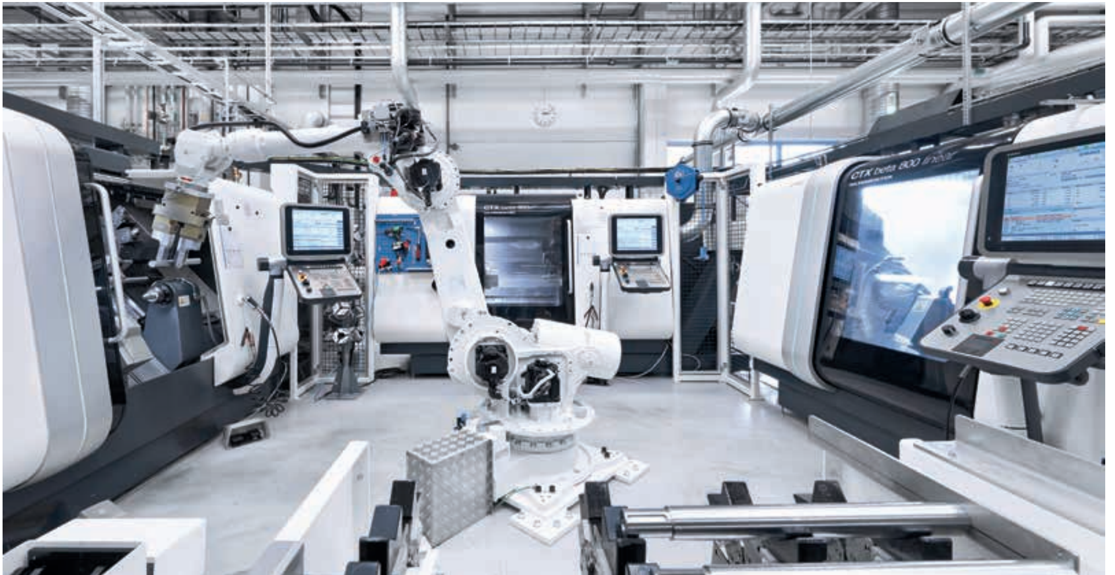
Eind 2013 heeft DMG MORI Systems een productiecel bestaande uit twee CTX beta 800 en een CTX beta 800 linear bij Xylem geïnstalleerd.
