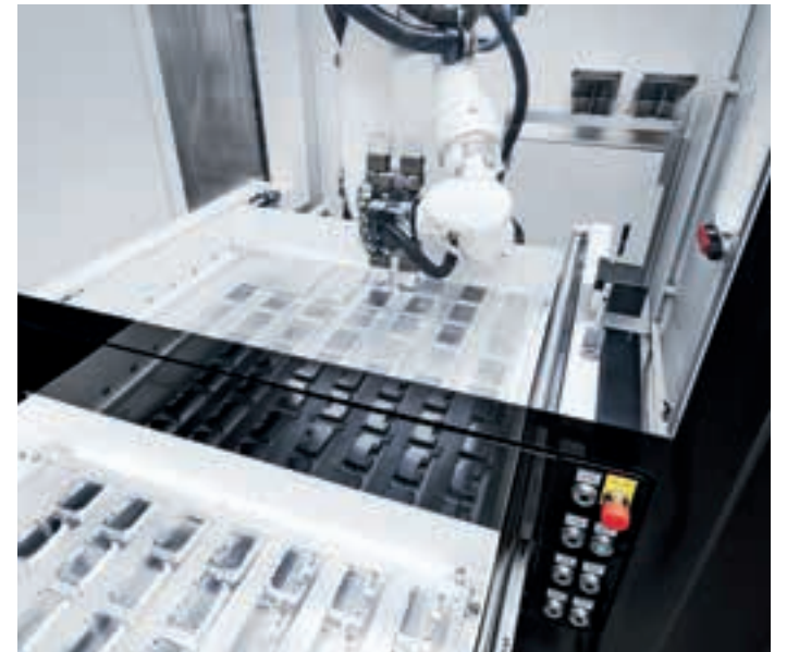
Het werkstukmagazijn met twee lades biedt voldoende plaats ook voor langere onbemande fases.
