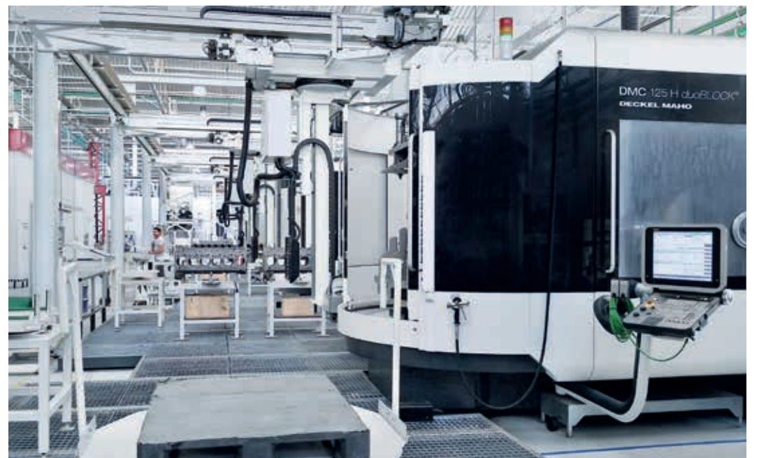
Bij FPT Industrial Argentina S.A. heeft DMG MORI Systems een productielijn met in totaal 13 DMC-bewerkingscentra als Turn-Key Project ontworpen.
