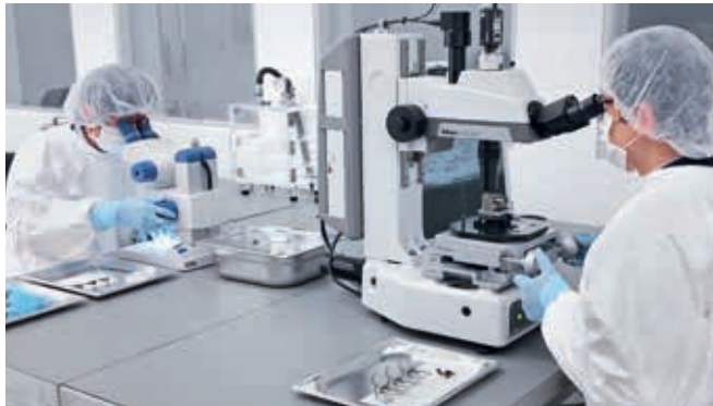
Nu op locatie Wernau: MR sensorafstelling met de microscoop op 2µm nauwkeurig.
