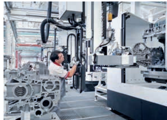
Aan de instelplaats worden componenten geladen. Op de voorgrond een draai-keerstation.
