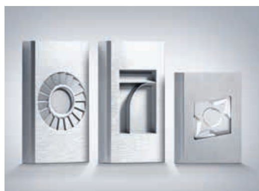
Laserbewerking van 3D-diepte contouren in hardmetaal d.m.v. picosecondelaser.
