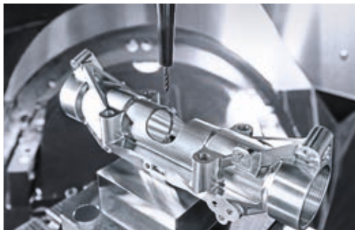
5-assige bewerking op een DMU 60 eVo.
