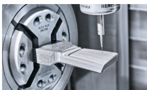
5-assen simultaan bewerking van de messen inzet voor walsfrees op de NTX 1000.
