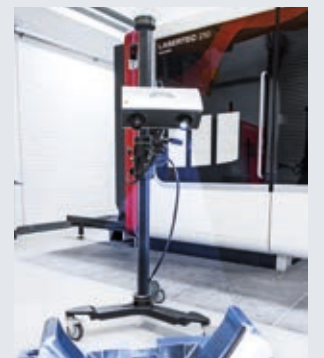
Metten van de gereedschap geometrie door middel van 3D-scanner.
