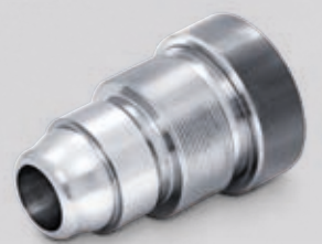
10 ø 60 x 100 mm Verbindingsstuk Materiaal: gelegeerd warmtebehandeld staal
