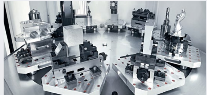
PH 150-8-voudig palletmagazijn; laadvermogen 250 kg incl. pallets (optioneel 350 kg)
