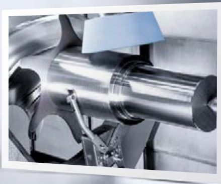
In-proces meting tijdens de slijpbewerking: Meet-herhaal-nauwkeurigheid van 5 µm.
