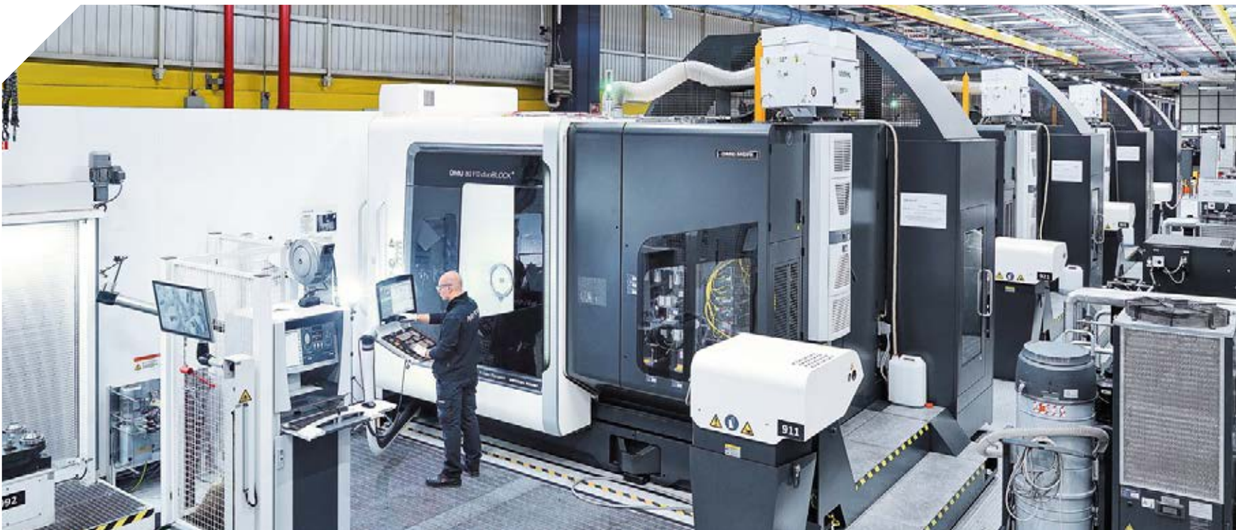
Op de individuele klant afgestemde automatisering: vier geautomatiseerde DMU 80 FD duoBLOCK machines aan één palletmagazijn.
