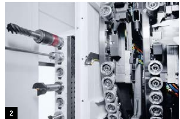
1. Perfecte ergonomie: In hoogte verstelbaar gereedschap laadstation voor instellen van sets van 8 gereedschappen à 30 kg incl. gereedschap identificatie. 2. Automatisch wisselen van het gereedschap uit het aanvoerstation in het wielmagazijn.
