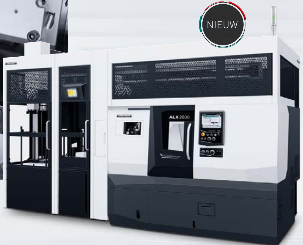
ALX 2500 met gantryloader GX15 voor werkstukken tot \varnothing 200 \times 150 mm
