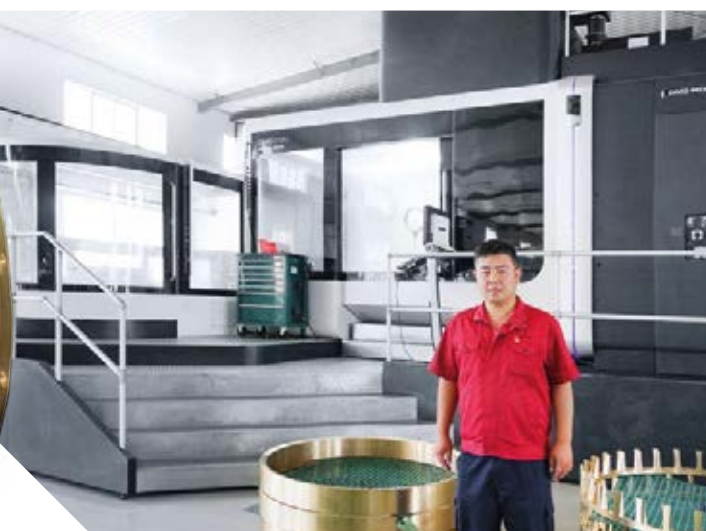
RUIGU's productiechef, de heer Chen, voor de DMC 210 U, waarop de zeer grote lagerkooien worden geproduceerd.
