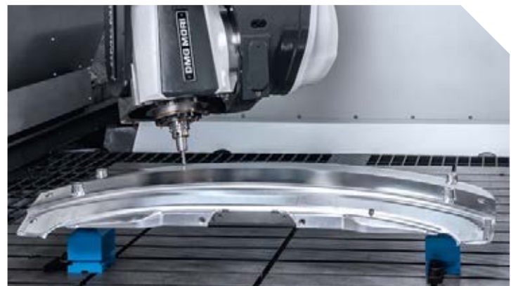
Die & Mold: 5-assige simultaanbewerking van een vormelement van aluminium.
