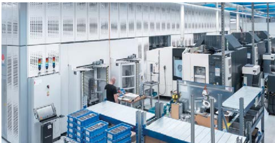
De grootste tot nu toe geïnstalleerde automatiseringsinstallatie bestaat uit drie DMC 60 H machines met elk een 5-voudig wielmagazijn voor 303 stuks gereedschap.
