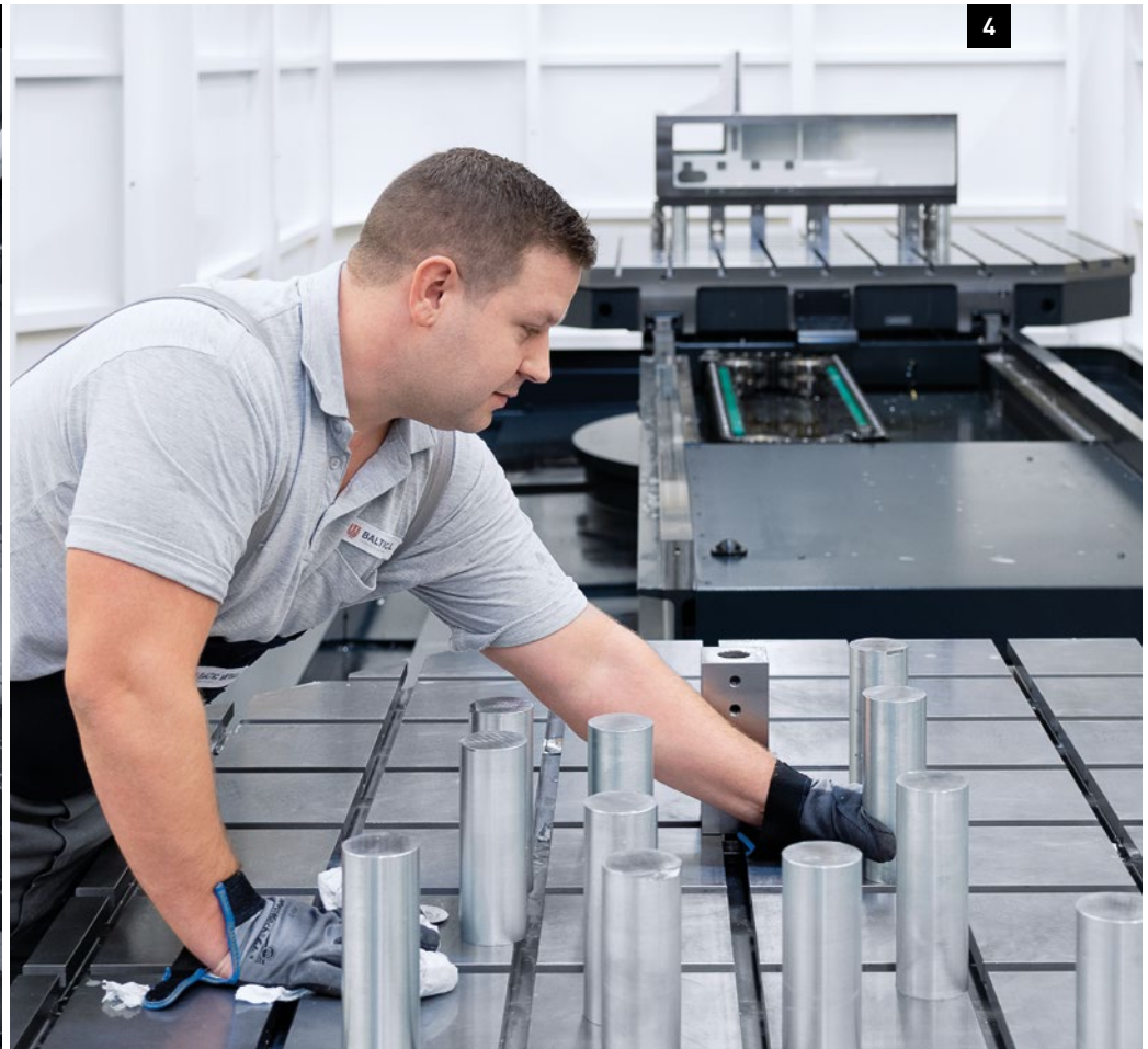
1. Thorsten Deumlich, Hoofd Bewerking grote werkstukken Baltic Metalltechnik GmbH 2./3. Op de DMC 340 U worden 5-assig complexe en uiterst precieze werkstukken voor de Hauni-groep bewerkt. 4. Operator Marc Hänel richt de werkstukken in voor bewerking en een speciale tafel met groeven vergemakkelijkt de inrichting.
