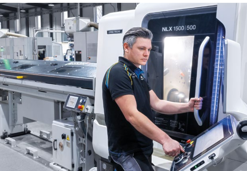
Eén operator is verantwoordelijk voor twee NLX 3000's en een geautomatiseerde NLX 1500 met stangenlaadmagazijn.
