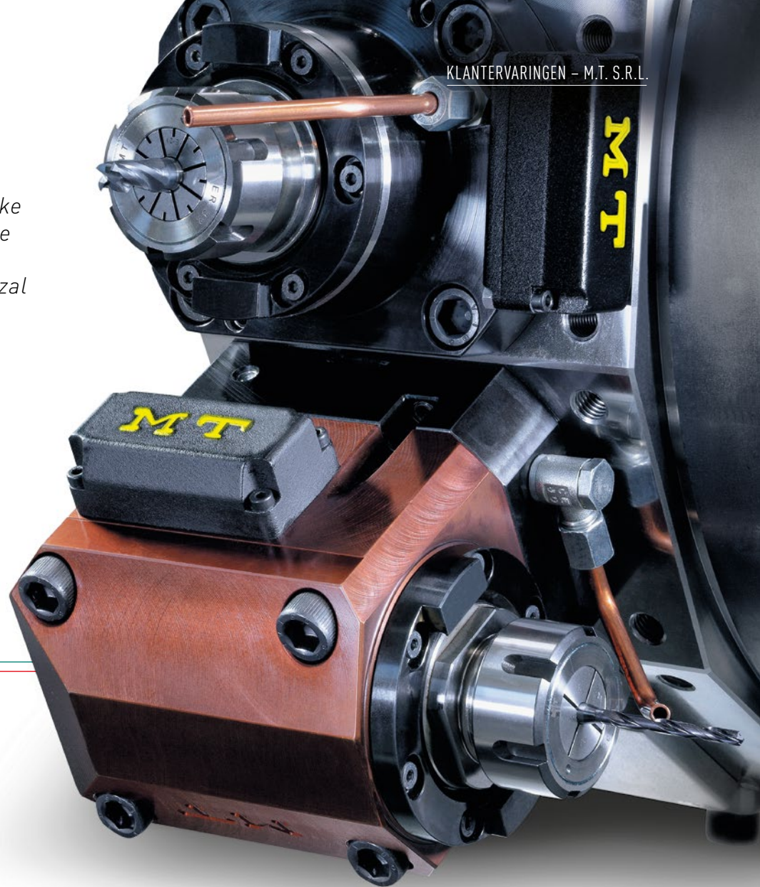
MT-gereedschaphouder inclusief MT-SmartLife module op de revolver van een NLX 2500.
