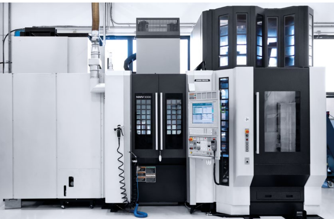
Dankzij het AWC-palletmagazijn kunnen op de NMV 3000 DCG 34 pallets voor werkstukken tot ø350 x 300 mm / max. 80 kg autonoom worden bewerkt. Dankzij het compacte ontwerp is het vloeroppervlak minder dan 3,8 m².
