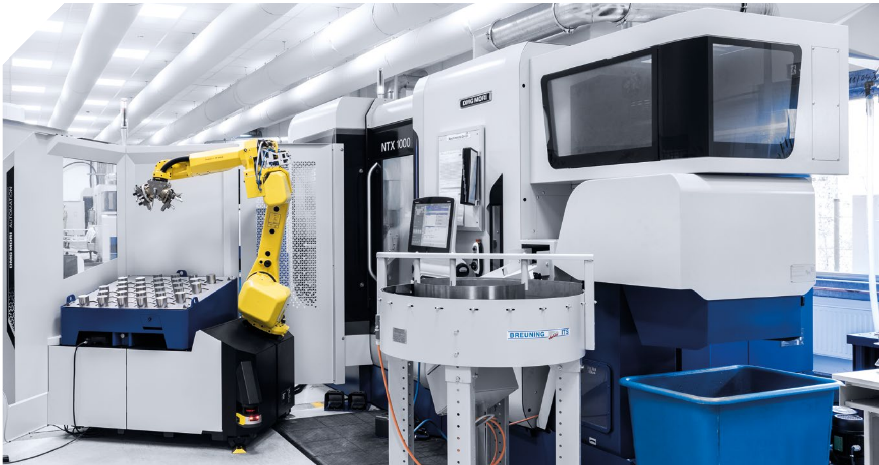
Tot de recentste investeringen van LINK behoren twee NTX 1000's met Robo2Go voor geautomatiseerde productie van heupkommen.
