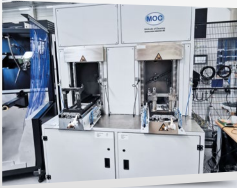
3. Het reinigingsstation bestaat uit twee reinigingscellen, één voor elk van de twee DMC 80 H duoBLOCK's, die zijn toegewezen aan een programma op de DMG MORI Cell Controller.
