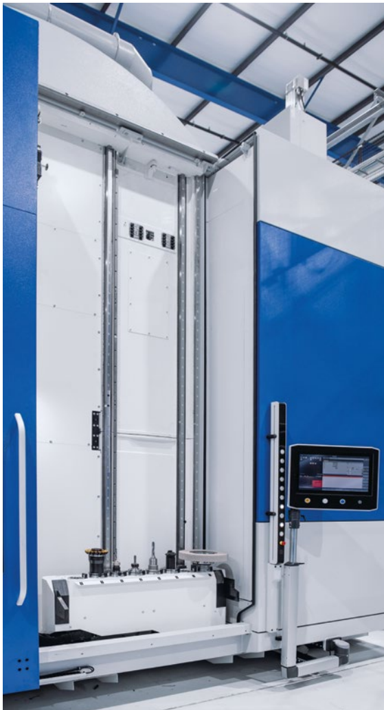
Met behulp van de TH-AGV kunnen tot 8 gereedschappen volautomatisch in sets worden gewisseld via het gereedschapinvoerstation.
