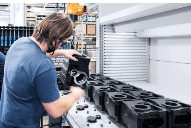
De productiecel wordt beladen via een automatisch onderdelenmagazijn. Bewerkte onderdelen worden hier ook weer uitgehaald.
