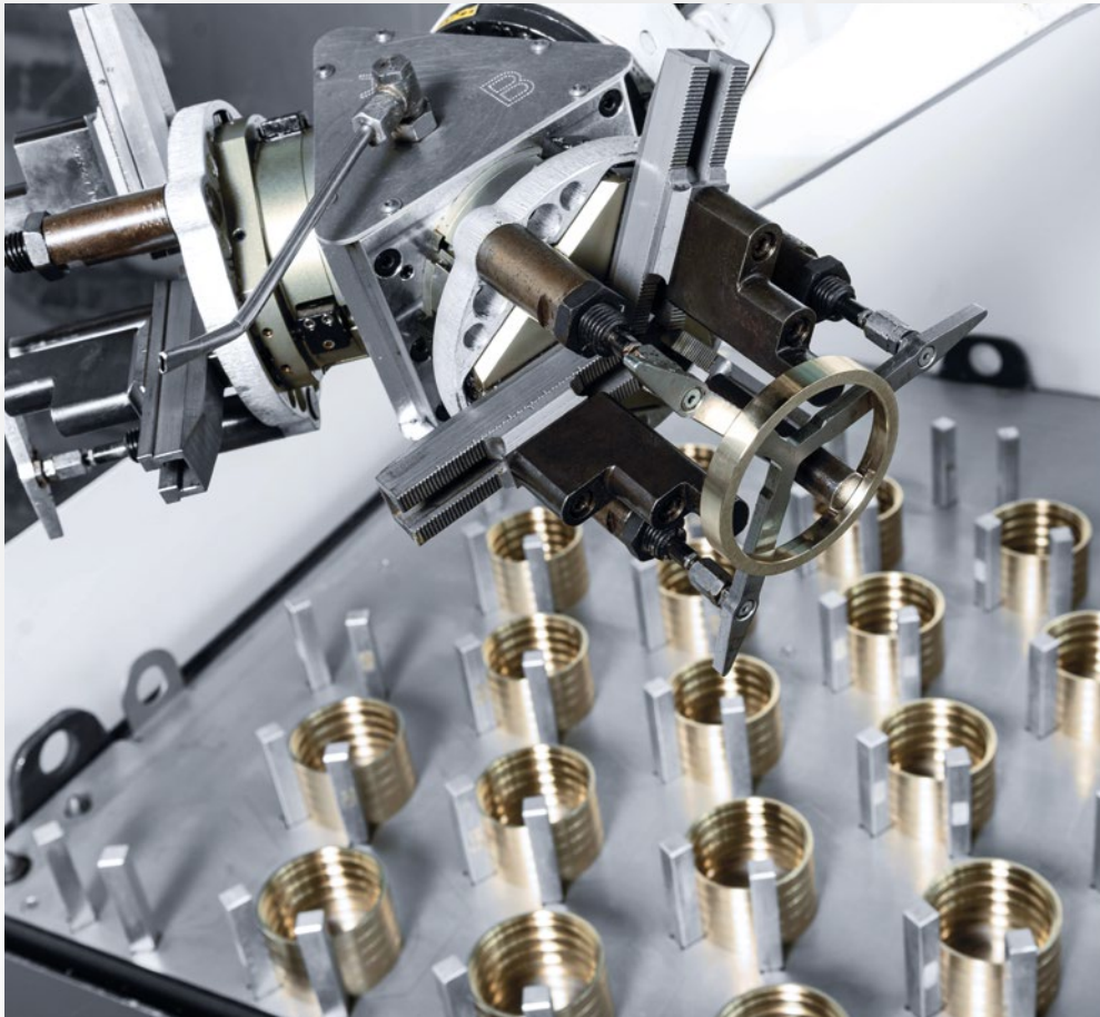
Het stapelmagazijn van de Robo2Go biedt voldoende ruimte, zodat de CTX beta 800 TC dag en nacht in bedrijf kan zijn.
