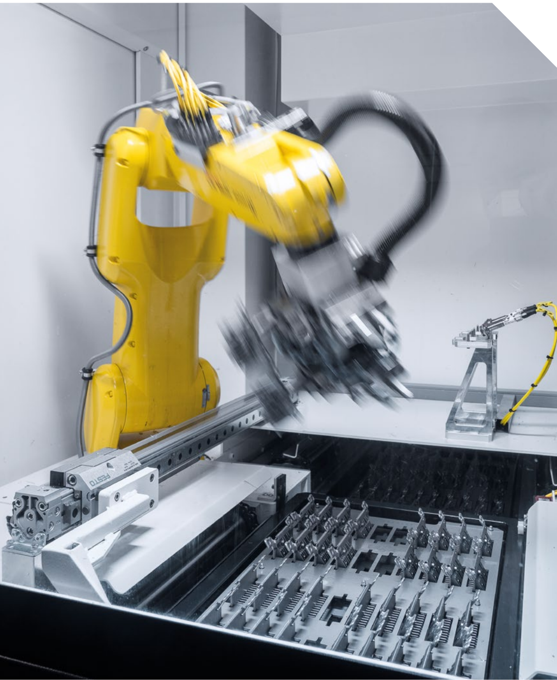
De werkstukopslag van de WH 3 op de DMP 70 biedt plaats aan maximaal 600 werkstukken en maakt zo autonome productie tot 15 uur mogelijk.
