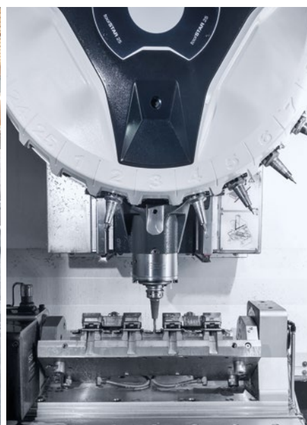
De kleminrichting werd speciaal ontworpen voor dit proces en biedt plaats aan 4 werkstukken.
