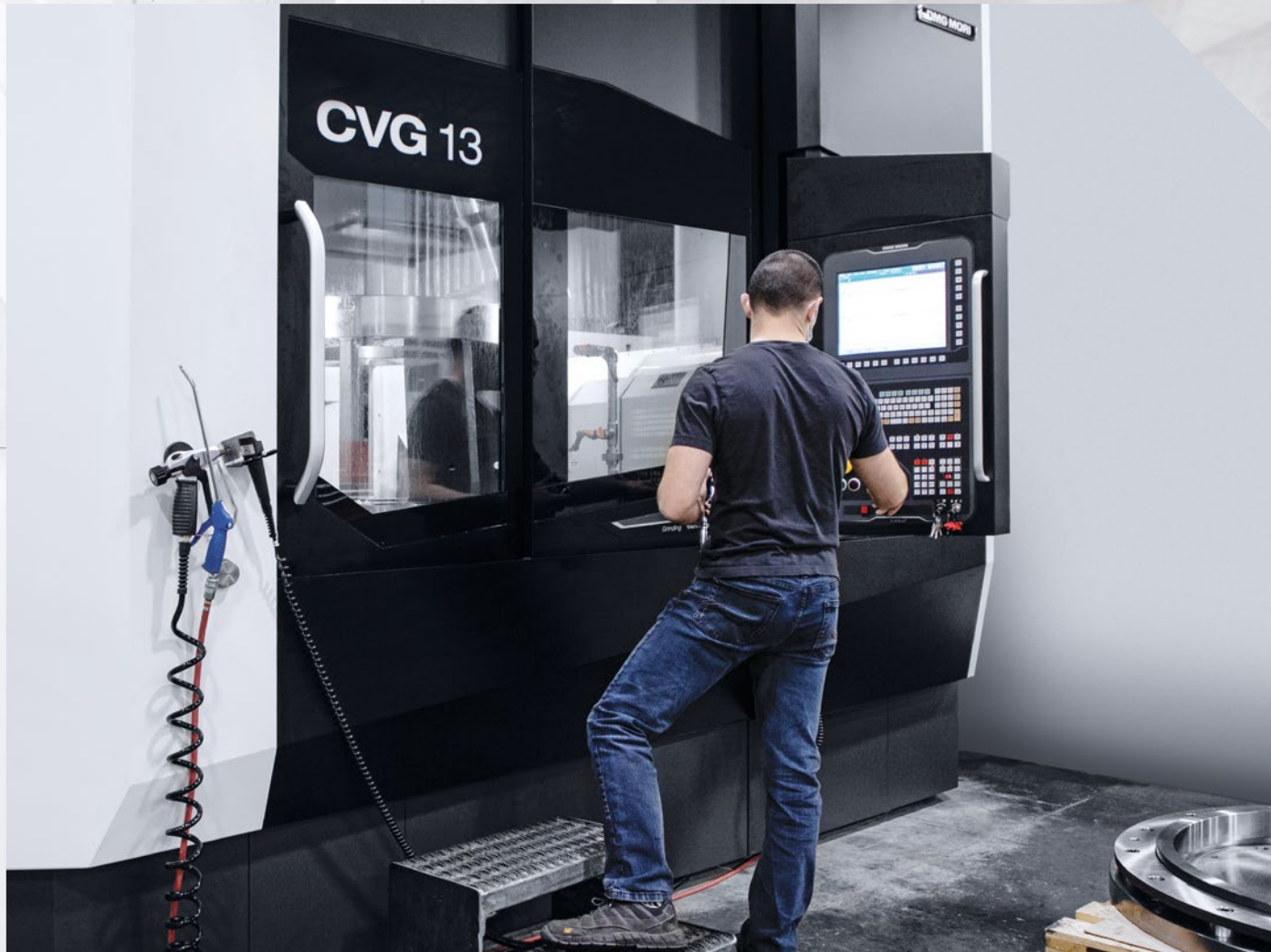
Voor de eindbewerking gebruikt NAMCO onder meer een CVG 13. Hier worden grote onderdelen met een diameter tot \varnothing 1.300 mm gepolijst.
