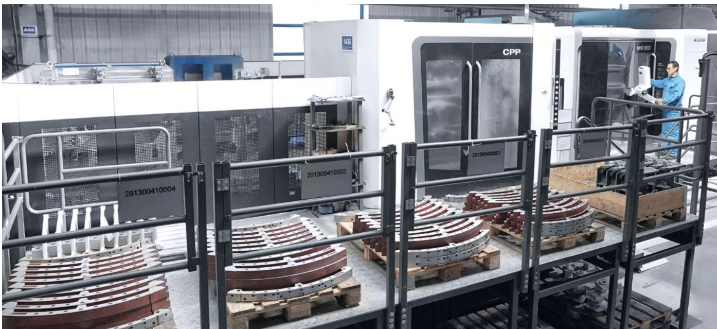
Voor de geautomatiseerde productie van grote componenten gebruikt Trützschler een NHX met een 7-voudige Carrier Pallet Pool (CPP).
