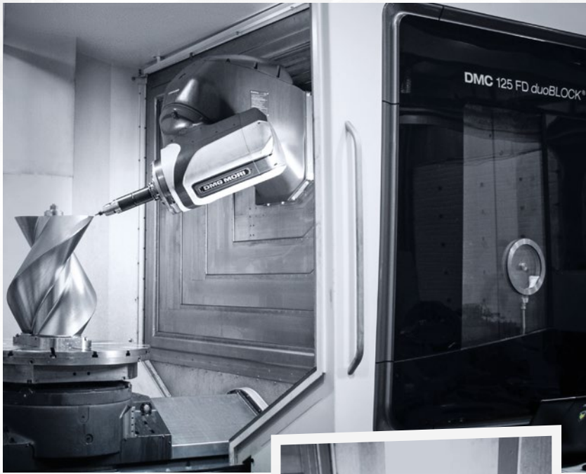
Op de DMC 125 FD duoBLOCK vervaardigt NAMCO tandwielen die zijn geprogrammeerd met de DMG MORI-software gearMILL, evenals andere complexe werkstukken.
